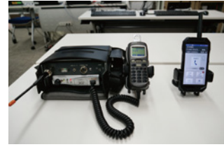
従来のMCA無線(左)とMCAアドバンス(右) 指令局アプリで端末の位置情報を地図上に表示
